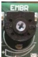
29) Para el correcto funcionamiento del Sistema Anti-aprisionamiento (por contacto) el embrague debe estar calibrado para el peso correcto del portón y el recurso de arranque y parada suave programada, después de la partida el motor debe parar, va aumentando la fuerza del embrague en el sentido + hasta que la puerta vuelva a andar, se ha efectuado el ajuste correcto de fuerza.
