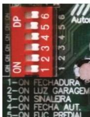
36) Para activar las funciones especiales basta con mover las llaves del DIP de programación a la posición ON, de fábrica todas las funciones vienen apagadas.
